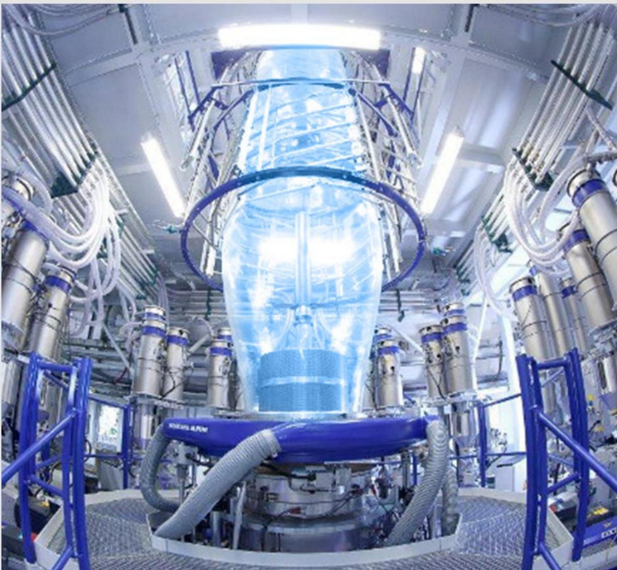
Blown ve Cast Ekstrüzyon teknolojisi ile gerçekleştirilen PE ve PP film üretimi, üretim safhasının ilk aşamasıdır. Granül halindeki polimer, fiziksel özelliklerini (terma, optik, mekanik, ebat, renk) bu safhada kazanmaktadır. Onplast, Ekstrüzyon teknolojisinin en gelişmiş imkanları ile, istenenilen hassasiyet ve ebatlarda, mono veya coex (5 kata kadar), üretim yapılabilmektedir.
